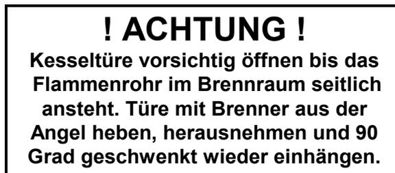
Position auf der Brennerhaube, an der der Aufkleber angebracht werden muß!
